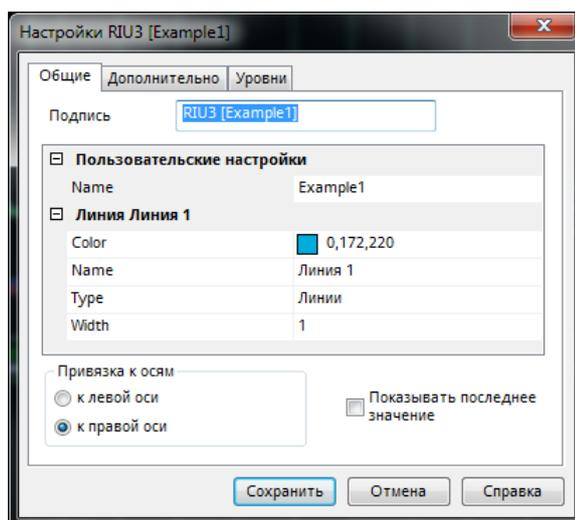
Как видно, значение поля Settings.Name попало в подпись нового индикатора и отображается в поле Name группы «Пользовательские настройки». Также в диалоге свойств индикатора присутствуют параметры одной линии с именем «Линия 1». Функция Init вернула 1, это говорит терминалу, что индикатор будет состоять из одной линии. Так как мы не описали в коде параметры этой линии, то значения полей Color, Name, Type, Width инициализируются значениями по умолчанию.
